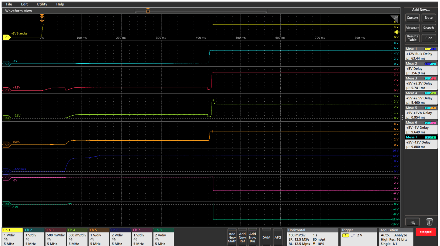
使用自动测量表征电源启动特点。
